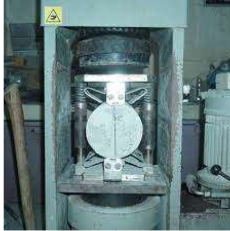
Gambar 2.23 Uji Kuat Tarik Belah Beton
