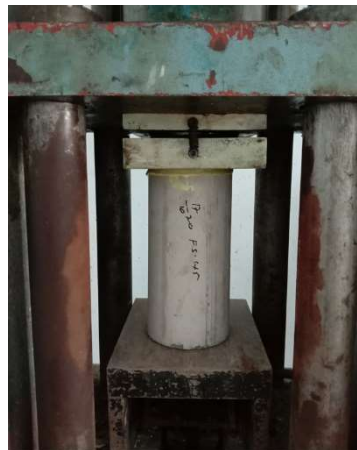
Gambar 2.22 Uji Kuat Tekan Beton
