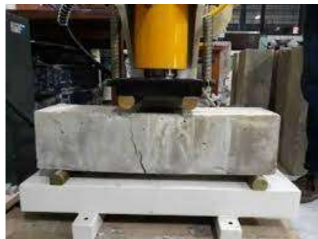
Gambar 2.23 Uji Lentur Beton
