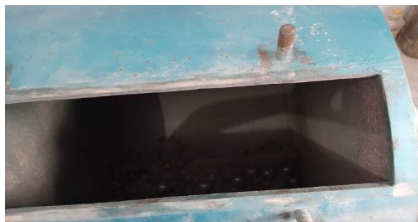
Gambar 3.28 Agregat Kasar + 11 Bola Baja dalam Mesin Los Angeles
