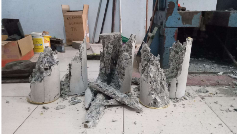
Gambar 5.11 Pola Runtuh Kuat Tekan Beton Mandiraja Banjarnegara
