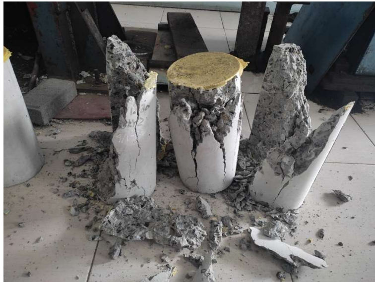
Gambar 5.6 Pola Runtuh Kuat Tekan Beton Kemangkon Purbalingga (Serayu)
