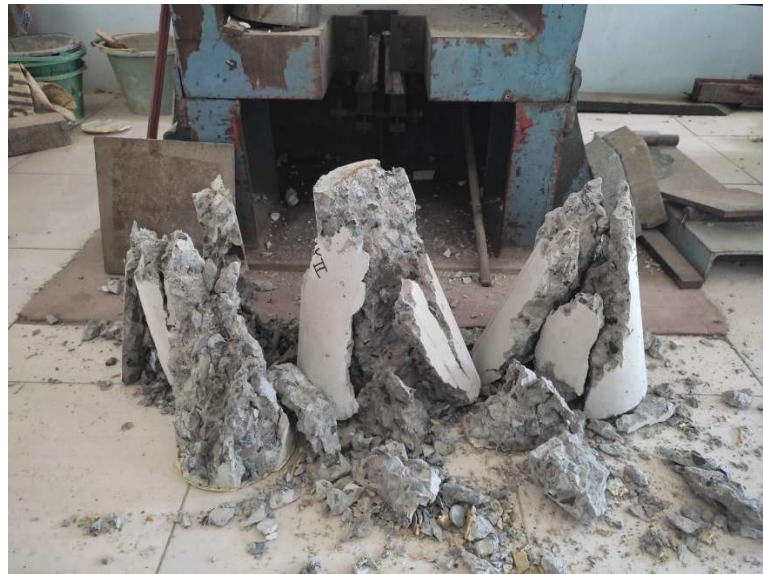
Gambar 5.12 Pola Runtuh Kuat Tekan Beton Bantarkawung Bumiayu
