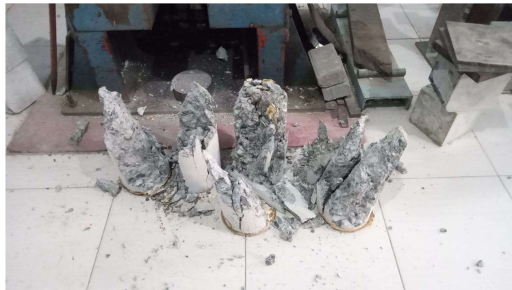
Gambar 5.7 Pola Runtuh Kuat Tekan Beton Singasari Karanglewas
